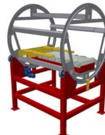
Flänshjulbana – Vertikalvändare. 3000 kg
