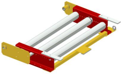
PA1500 – Grind vid brandport. Hålls nere av elektromagneter. Fälls upp av motvikt
