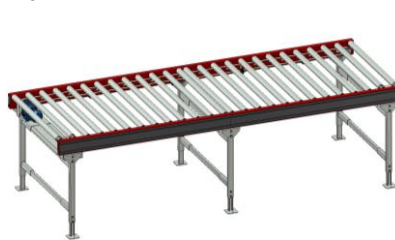
FR600 – Rullbana, driven ackumulerande. Flatremsdriven. För gods som väger 150 kg/m
