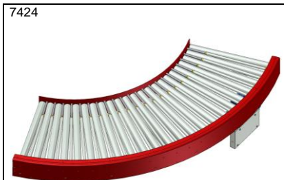
KE500 – Kurva, driven 90°. Med små odrivna stödrullar mellan de drivna rullarna
