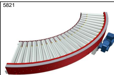
KE100 – Kurva, driven 90°. Med små odrivna stödrullar mellan de drivna rullarna
