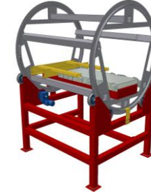
Flänshjulbana – Vertikalvändare. 3000 kg
